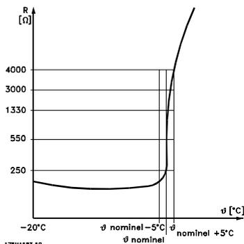
Если в двигателе предусмотрено термореле Klixon, оно также может быть подключено к этому входу. Если двигатели включены параллельно, то термисторы/термореле могут быть включены последовательно (суммарное сопротивление меньше 3 кОм).
