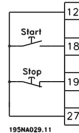
*Импульсный пуск*: если импульс подается в течение не менее 14 мс, преобразователь частоты запустит двигатель при условии, что не поступила команда останова. Двигатель может быть остановлен кратковременным включением функции *Останов, инверсный*.
